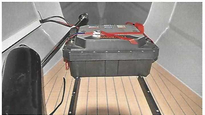
Der Akkublock im Vorschiff, ein zweiter kann im Heck eingebaut werden.
