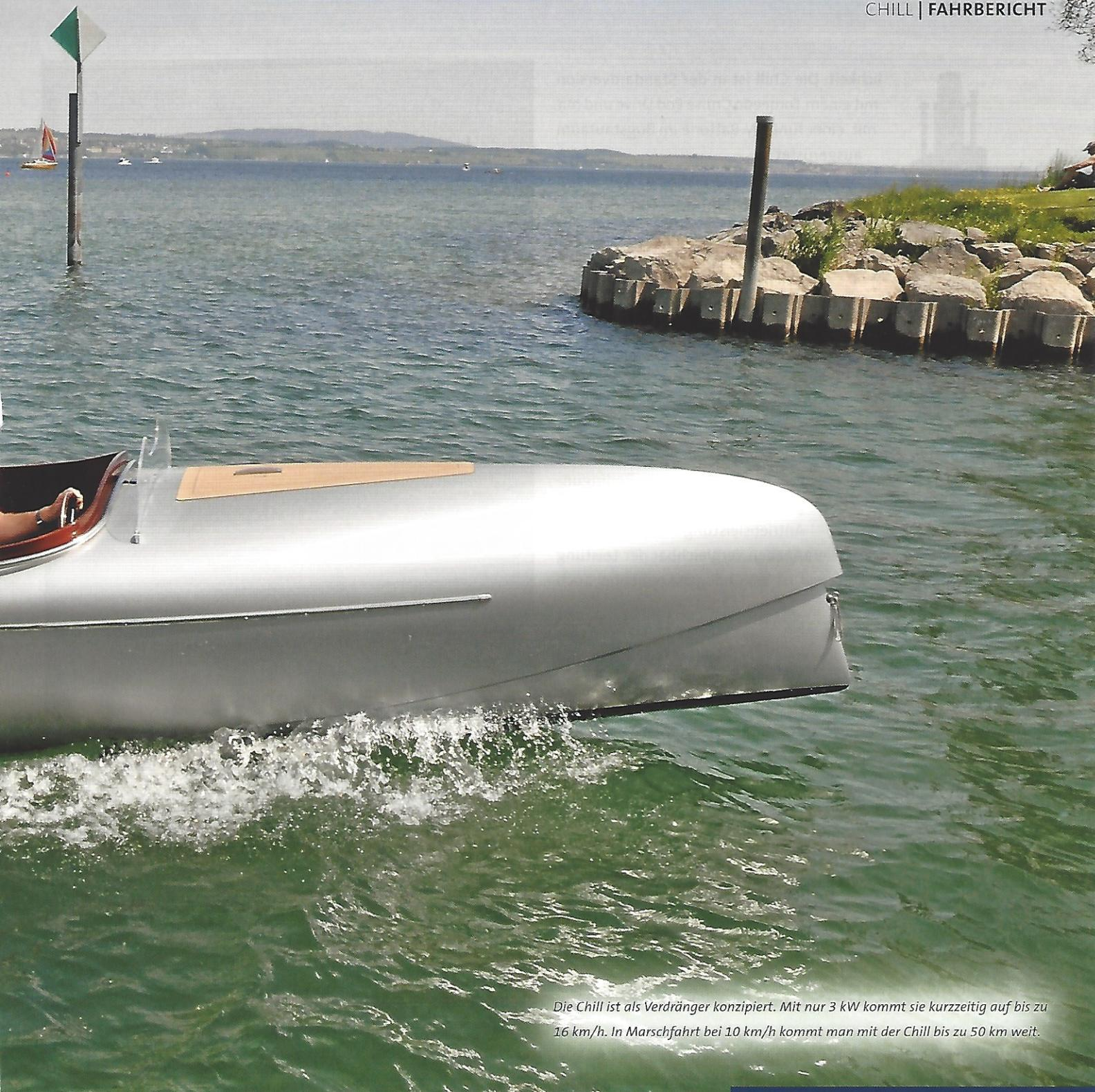
*Die Chill ist als Verdränger konzipiert. Mit nur 3 kW kommt sie kurzzeitig auf bis zu 16 km/h. In Marschfahrt bei 10 km/h kommt man mit der Chill bis zu 50 km weit.*
