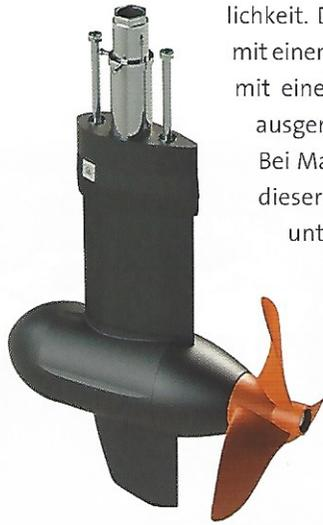
Ein drehbarer Pod Drive treibt die Chill an und steuert sie. Bild: Torqeedo
