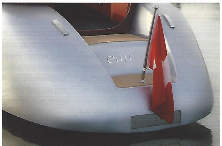
Das Heck mit zwei Stufen und der versenkten Badeleiter für den Wasserzugang.
