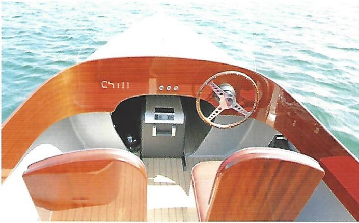
Der Steuerstand mit der Schaltboxen. Schalter sind auf ein Minimum beschränkt. Das Steuerrad ist wählbar unter verschiedenen Replikas.
