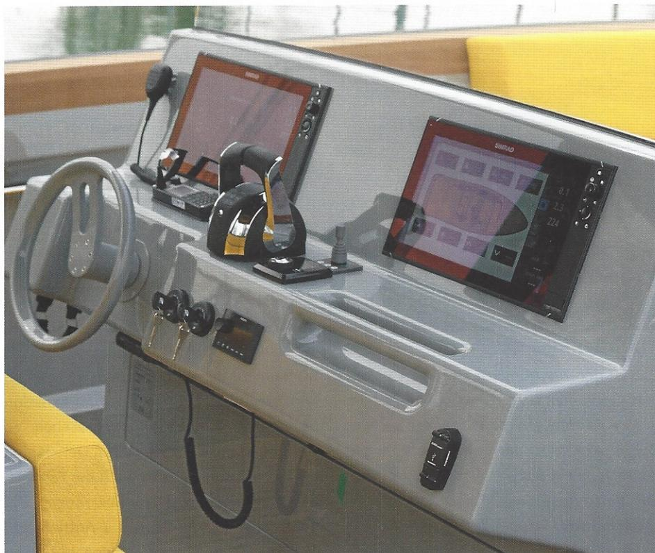
Die Konsole mit lackiertem Steuerrad und elektronischer Motorsteuerung. Daneben das Trimmsystem und der Hebel für's Bugstrahlruder. Die beiden Touchscreens sind redundant. Normalerweise werden auf dem linken Display die navigatorischen Daten und die Motordaten dargestellt und auf dem rechten Display die Bordelektrik. Diese kann vom Bildschirm aus auch geschaltet werden. Auf der Konsole das interne Funkgerät. Das UKW-Seefunkgerät befindet sich unter der Konsole.
