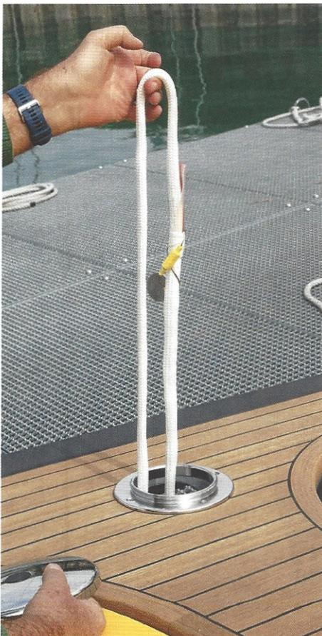
Der Heißstropf verschwindet unter Deck.
