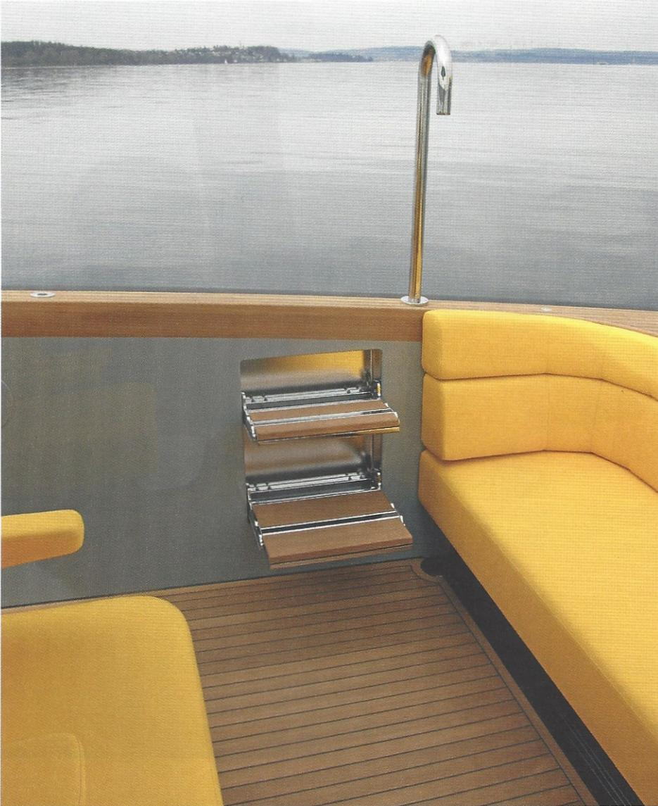
*Nicht nur konstruktiv sondern auch handwerklich auf sehr hohem Niveau: Die klappbare Treppe mit klappbaren Stufen besteht aus vielen kleinen Bauteilen...*
