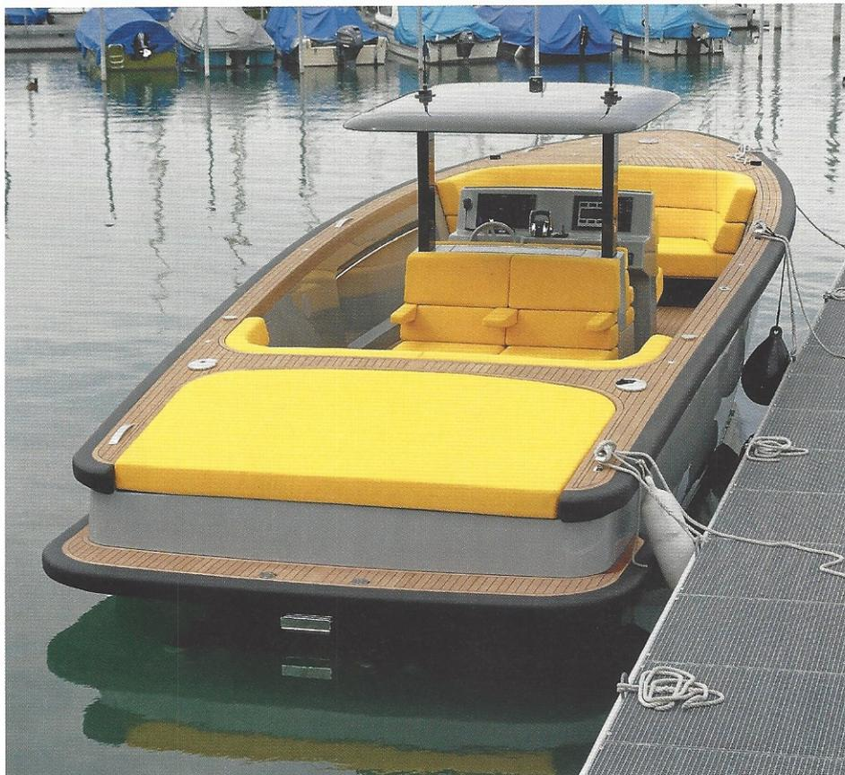
Das Heck mit Plattform und Badeleiter. Der ursprünglich geplante Weg von hier in die Plicht musste der Sonnenliege weichen. Die rundum verlaufende Scheuerleiste aus weichem, geschäumtem Gummimaterial erlaubt auch ein Anlegen bei rauer See sowohl an einer Kaimauer als auch an der Mutteryacht.
